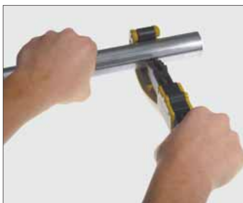
■ Отрезание трубы при помощи трубореза.
