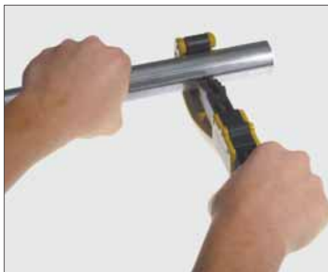
■ Отрезание трубы при помощи трубореза.
