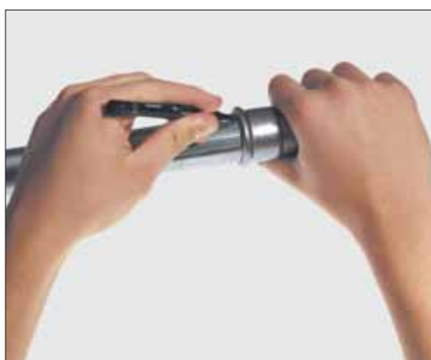
■ Отметка требуемой глубины вставки.
